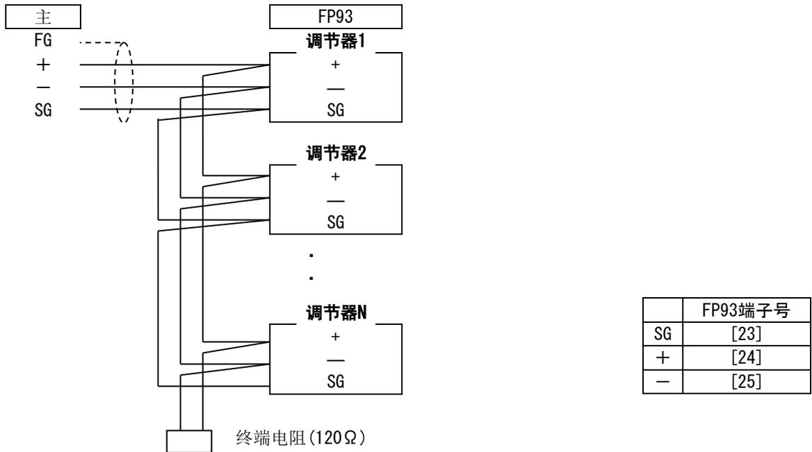
注1: RS-485时需要在端子 (+和-) 接入1/2W 120Ω 的终端电阻后使用，终端电阻只需安装在最末一台调节器上。如果终端电阻安装在一台以上的调节器上，则不能保证操作。
